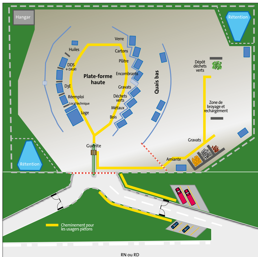
Figure 4. Exemple de cheminement pour les usagers piétons dans une déchèterie
